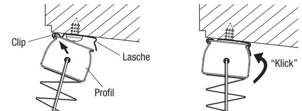
Zur **Demontage** drücken Sie die Lasche des Clips hoch, um das Profil aus dem Clip entnehmen zu können.
